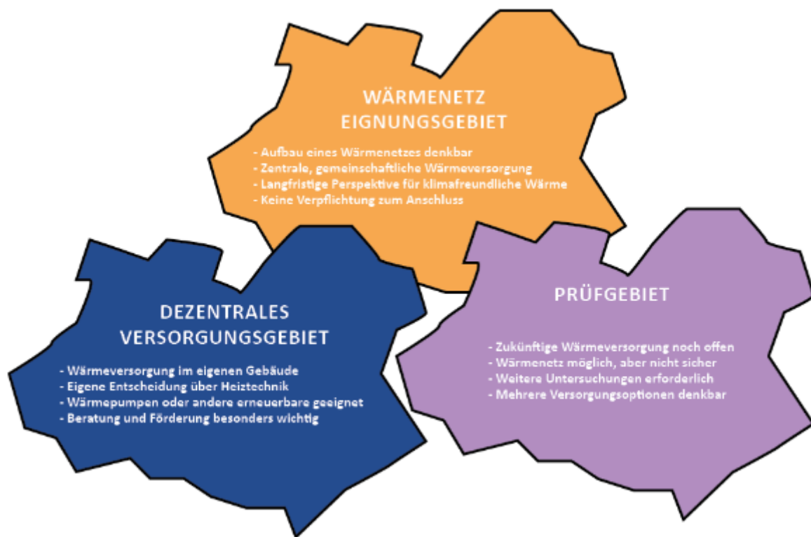
Abbildung 38 Übersicht der Arten von Wärmeversorgungsgebieten
