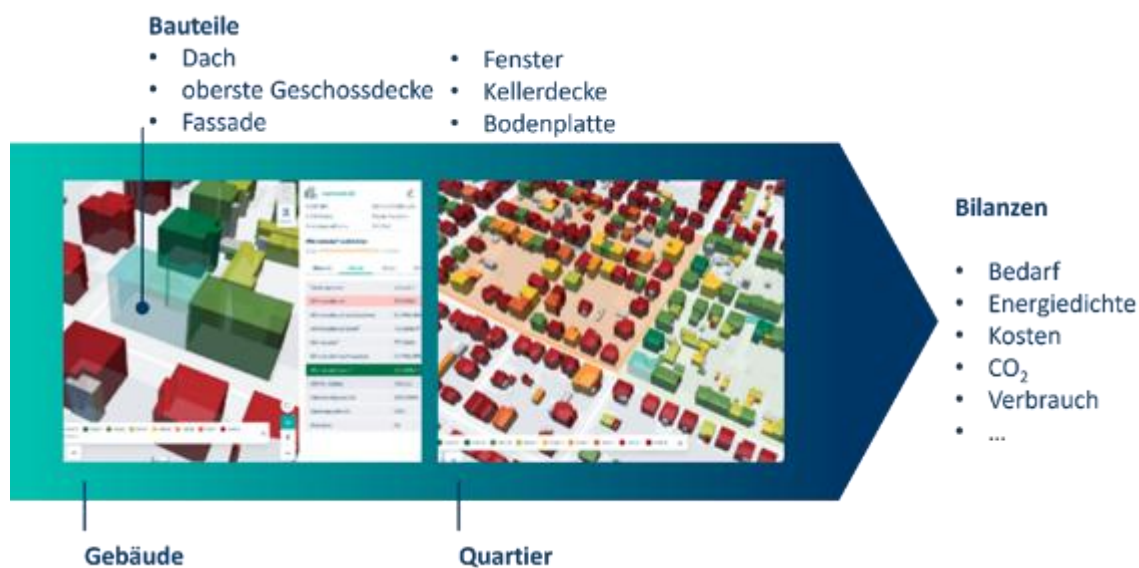
Abbildung 6: Schematische Darstellung des digitalen Gebäudemodells(ENEKA)
